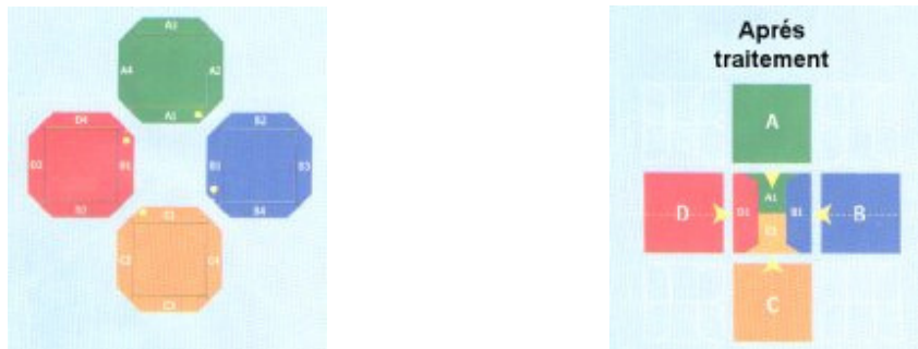
Figure 21 : constitution d'un pixel
