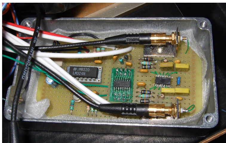
FIG. 28 – Carte électronique d'amplification réalisée
